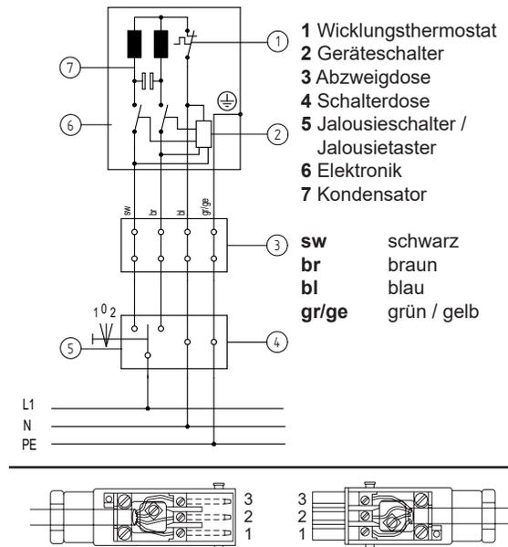
Fig. 5 Schaltbild SunTop/Z M RH 230 V / 50 Hz und Kabelbelegung bei Verwendung mit Hirschmann-Steckverbindung STAS-3
