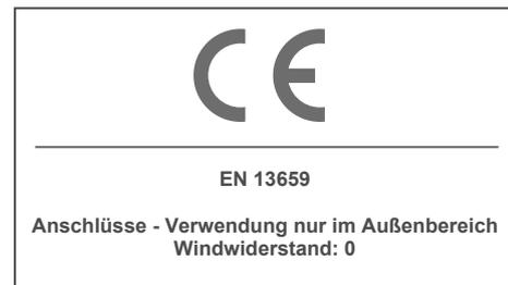
Aufgrund mechanischer Unzulänglichkeiten der Testbeschreibung in der gültigen Prüfnorm DIN EN 1932 kann für Raffstore keine sinnvolle Klassifizierung angegeben werden. Es gilt die Windwiderstandsklasse 0.
