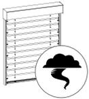
Die Zulässige Windstärke bis der Raffstorebehang hochgefahren wird, ist individuell zu beurteilen und wird vom Fachbetrieb festgelegt.
