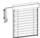
Untersuchen Sie den Raffstore und die Bedienelemente regelmäßig auf Anzeichen von Verschleiß und Beschädigung und das Produkt auf Standfestigkeit. Die Inspektion und Wartung von elektrischen Bauteilen muss von Fachbetrieben durchgeführt werden.
