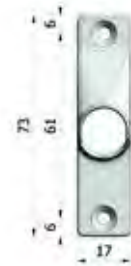
Gelenklager 17x73 mm Zinkdruckguss, bis 55°
