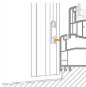
Abdichtung zum Fenster
