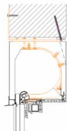
Monolithisches Mauerwerk zusätzlicher Montagewinkel
