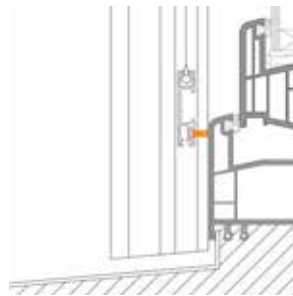
Abdichtung zum Fenster
