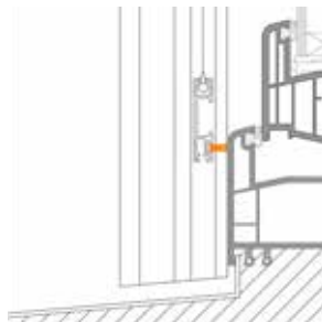
Abdichtung zum Fenster
