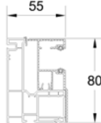
AE Einzelführung PVC/ALU Kunststoff Basisprofil Aluminium Führungsschiene
